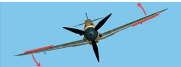
Manche à droite, la portance de l'aile droite diminue, celle de l'aile gauche augmente, l'avion effectue une rotation vers la droite.
