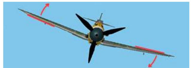
Manche à gauche, la portance de l'aile gauche diminue, celle de l'aile droite augmente, l'avion effectue une rotation vers la gauche.
